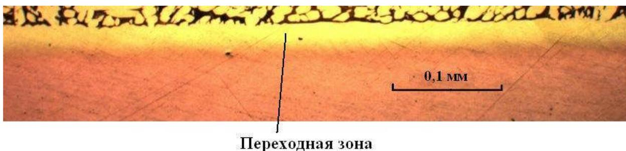
Рисунок 3 – Переходная зона диффузионного слоя после термообработки меди с АД1 / НП2 покрытием при 700°С в течение 6ч
