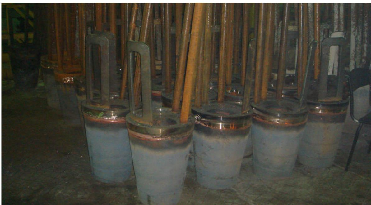
Рисунок 8 – Фурмы с никельсодержащим защитным покрытием
